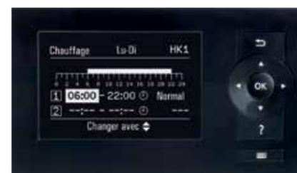
Régulation Vitotronic – facilité d'utilisation grâce à une navigation simple et à un large écran bien lisible, p. ex. pour régler les temps de commutation.
